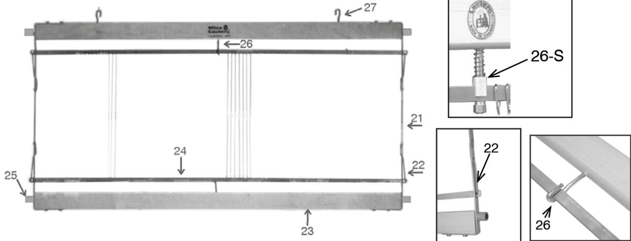
Les cadres de lames pour les Dorothy 15 $\frac{3}{4}$ " et 24" sont en métal. Les cadres de lames des métiers Compact 24" sont de bois avec des supports d'aiguilles en métal. Les cadres de lames des autres métiers sont de bois (haut et bas) et métal (bout et support aiguilles).
